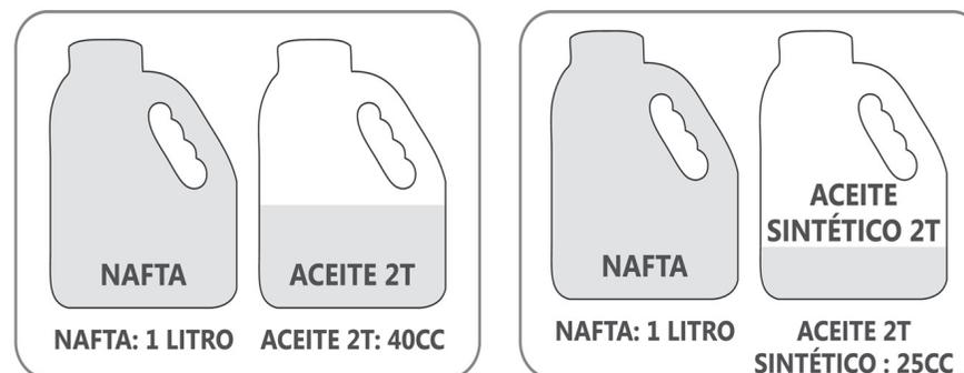
EL NO RESPETAR ESTAS PROPORCIONES DE MEZCLA IMPLICA EL **DESPERFECTO EN EL FUNCIONAMIENTO DE LA MÁQUINA Y LA PERDIDA DE LA GARANTÍA**, PREVIO A UN ANÁLISIS DE UN SERVICIO TÉCNICO AUTORIZADO.
